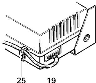
5. Als trekcontlasting van de kabel van het bedieningselement (19) door middel van de ingesloten kabelbinder (25) aan de regel-elektronica beveiligen.
