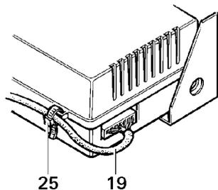
5. Als Zugentlastung das Bedienteilkabel (19) mittels beiliegendem Kabelbinder (25) an der Steuerelektronik sichern.
