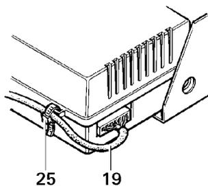
5. En tant que délestage de traction, attacher le câble de la pièce de commande (19) à l'aide du collier fourni (25) au niveau du système électronique de commande.
