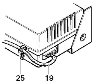
5. Som strekkavlastning skal betjeningsdelens kabel (19) sikres på styreelektronikken ved hjelp av den vedlagte kabelbinderen (25).
