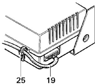
5. Per eliminare la trazione, fissare il cavo dell'unità di comando (19) al dispositivo elettronico di comando con il fermo fornito (25).
