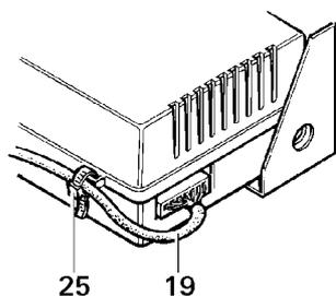
5. Jako ochronę przed wyciągnięciem zabezpieczyć kabel elementu obsługi (19) za pomocą załączonego łącznika kabli (25) na module elektroniki sterowania.
