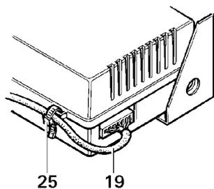
5. Säkra manöverdelskabeln (19) vid det elektroniska styraggregatet med den bifogade kabelbindningen (25) för att undvika dragbelastning.
