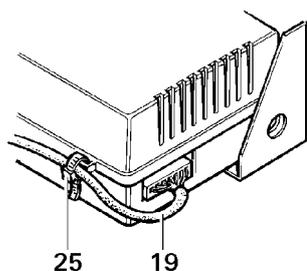
5. Kiinnitä käyttöosan kaapeli (19) ohjauselektronikkaan mukana toimitettua vedonpoistimena toimivaa kaapelinjatkosta (25) käyttäen.
