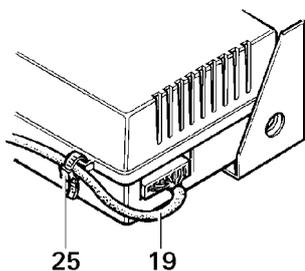
5. Som trækaflastning skal betjeningsdelens kabel (19) sikres på styreelektronikken med den vedlagte kabelbinder (25).
